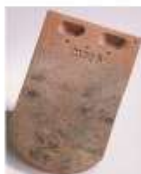
Tuile mécanique écaillée
